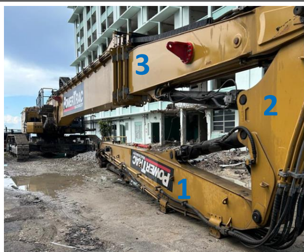
Lança contendo: braço articulado (1 de 8.25m, 2 de 2.4m) e lança telescópica 3 de 36,956m
